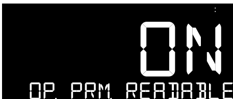
Fig. 36: Lectura de parámetros de funcionamiento habilitada
