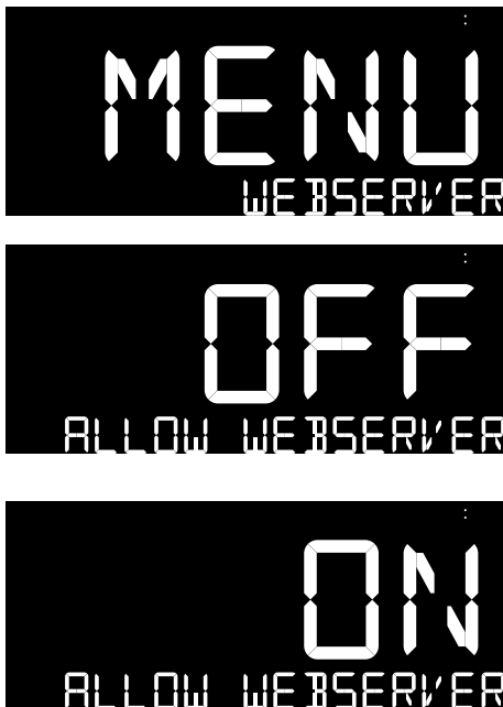
Fig. 31: Acceso al servidor web habilitado
