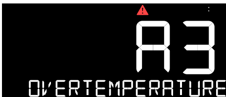
Fig. 39: Ejemplo: alarma de exceso de temperatura activa A3
